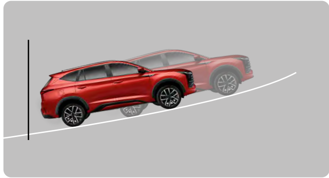
HAS (Asystent ruszania pod górę) Ułatwia ruszanie na pochyłościach, zapobiegając cofaniu się pojazdu podczas startu pod górę.
